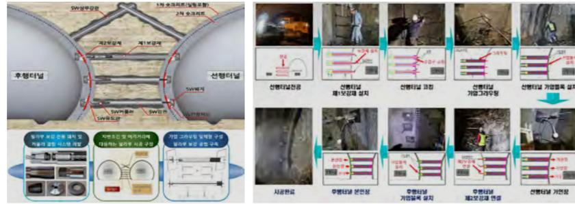
건설신기술 965호는 웨이 조립과 정착이 가능한 양방향 커플러에 강관 및 강연선 또는 바를 결합하고 코킹 및 그라우트를 주입하는 필라부 보강 공법으로 선행터널과 후행터널의 보강재를 단계적 일체형으로 결합하고 가압적 그라우팅을 시행하기에 구조적 안정성을 실현한 근접병설터널 보강시스템이다. 단계적으로 선행터널과 후행터널에 양방향 커플러의 강관 및 강연선 또는 바를 적용하여 필라부 보강을 시행하는 본 신기술의 활용은 지형, 지질, 시공 방법에 따라 근접병설터널의 이격거리를 좁힐 수 있다는 이해를 확산시키고 필라의 구성방법, 제어적 굴착, 보강기술 개량으로 안정적 시공을 수행할 것이라 전망된다. (개발자 : ㈜성우사면, ㈜수성엔지니어링, ㈜지승씨앤아이)
