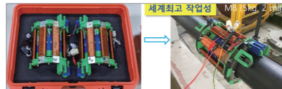
〈그림 4〉 전자기 센서의 분리/조립 된 모습 (실물사진)
